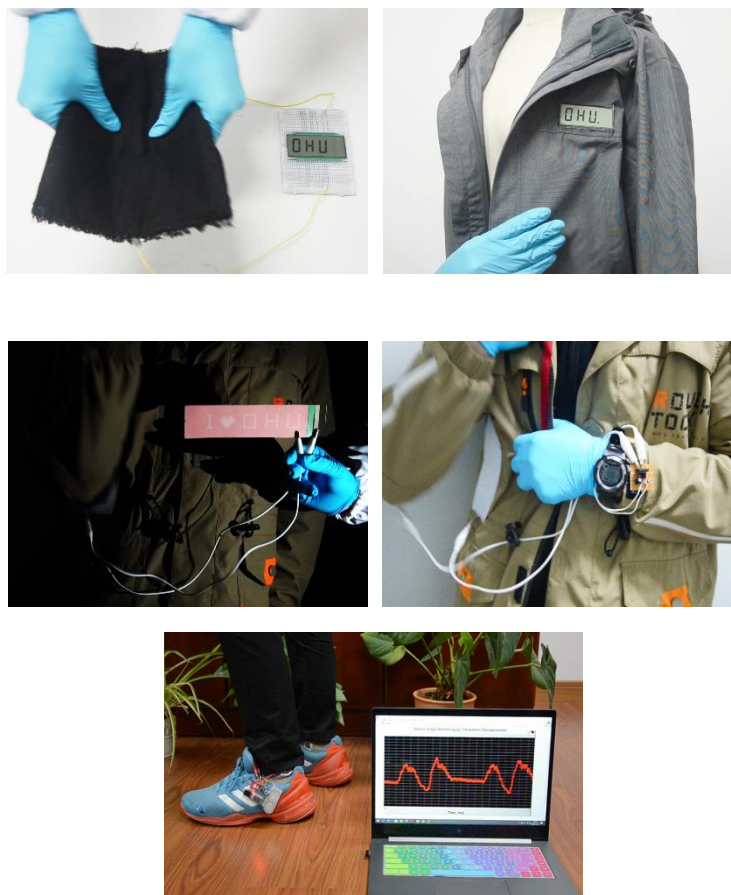
图7 弯折电子纺织品驱动LCD,电子纺织品驱动数字化发光点阵,电子纺织品驱动可穿戴电子手表及电子纺织品捕捉足部运动姿态
